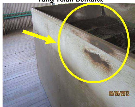
Gambar 6.8 Tempat Pengeringan Daun Teh Yang Telah Berkarat
